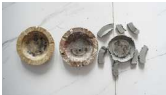
Figure 1. Kondisi asbak hasil daur ulang setelah uji panas dan uji benturan pada variasi campuran plastik PET+PP, PP+HDPE, dan PET+HDPE
