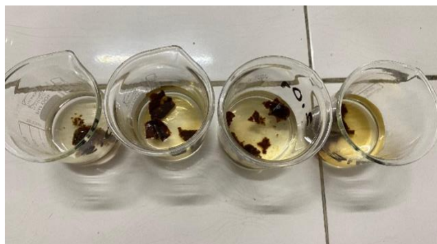
Gambar 4. Uji Daya Serap Air
